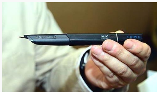
Neo.1 スマート・ペンは光センサーによる 文字認識が搭載されている
